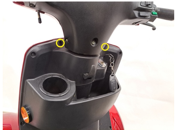
Irrota ylemmän etukatteen ylämuovin kiinnitysruuvit. (ristipäämeisseli ph2).
