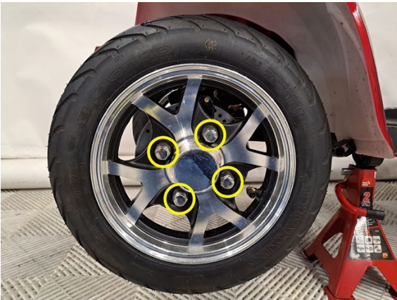
Irrota kummaltakin puolelta etupyörien kiinnitysmutterit. (hylsy 19 mm).
