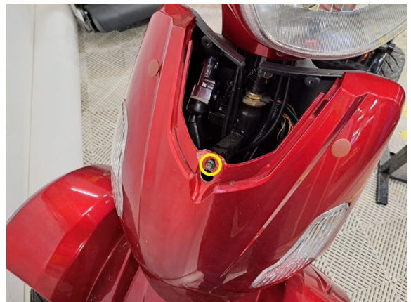
Irrota ylemmän etukatteen kiinnityspultti. (hylsy 8 mm).
