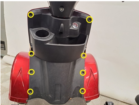
Irrota ylemmän etukatteen kiinnitysruuvit. (ristipäämeisseli ph2).
